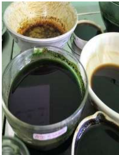
Gambar 3 proses penguapan sampel pada waterbath
