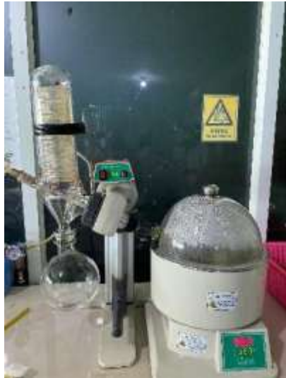
Gambar 5 Proses pemisahan pelarut menggunakan rotary evaporator
