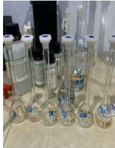
Gambar.8 Pembuatan larutan standar
